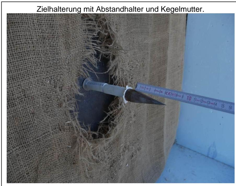
Die Befestigung des Vogelzieles erfolgt unverändert durch eine kegelförmige, spitz zulaufende Mutter aus Stahl. Die Abmessungen entsprechen den Angaben im Gutachten des SSV Wiskamp.
