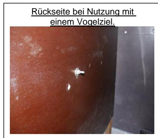
Wird ein Vogelziel verspannt, muss das nicht genutzte 8 mm Bohrloch verschlossen werden, da ansonsten die Gefahr eines Durchschusses besteht. Dies kann mittels Senkkopfschraube (bündig zur Stahlrückwandinnenseite) und gekonterter Sicherung auf der Rückseite erfolgen.
