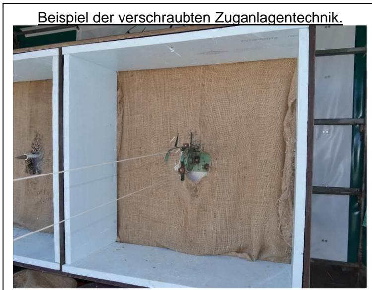
Zur sicheren Fixierung der Zusanlage im Geschossfang ist das Stahlelement mit zwei 8 mm starken Gewindestangen ausgestattet.
