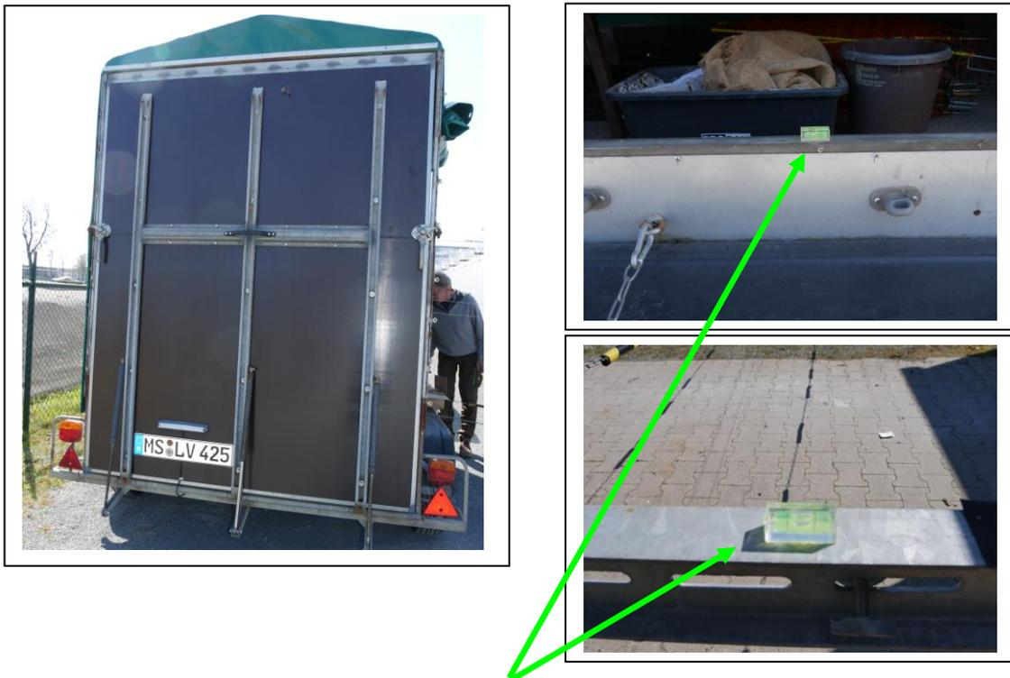
Der Anhänger, sowie die Querstrebe zwischen den Gewehrhalterungen sind mit Libellen ausgestattet. Eine entsprechende Ausrichtung kann mit diesen einfachen Hilfsmitteln sichergestellt werden.
